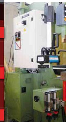
Per riprendere basterà rilasciare e ripremere il pedale di comando. Questa modifica concorre ad una **notevole riduzione dei tempi di intervento del dispositivo di sicurezza**. In modalità **blanking** sarà possibile la realizzazione di scatolati senza perdita di produttività ed in completa sicurezza.
