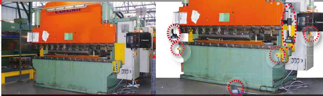
Il cuore del sistema di sicurezza è il **DSP Laser multiraggio Nuova Elettronica**, costituito da una centralina di sicurezza in Classe SIL 3 (max standard richiesto) collegata ad un proiettore laser ed ad un ricevitore.
